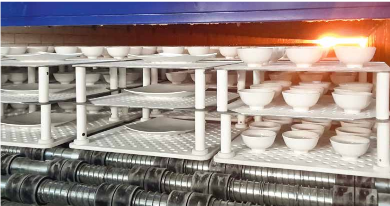
Einblick in einen Rollenofen: Hier wird Porzellan hergestellt.
